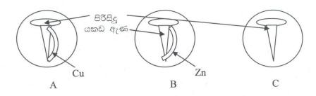
ඉහත සඳහත් වන්නේ A, B, C පෙලිිදිසි තුනකට එගාර් මාධා යොදා එයට පිනොප්තලීන් හා K<sub>3</sub>FeCN<sub>6</sub> එක්කර යකඩ විඛාදනය පිළිබඳව කරනු ලබන පරීකෂණයක පරීකෂණ ඇටවුමකි. ඒ ඇසුරෙන් අසා ඇති පුශ්නවලට පිළිතුරු සපයන්න.
